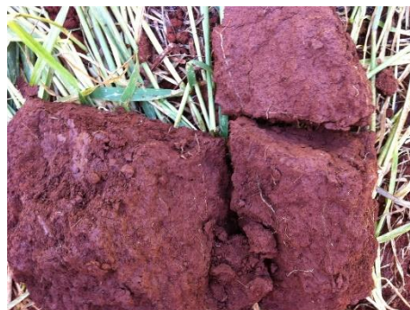
Figura 3 – Agregado retirado entre 0,40 – 0,60 m de profundidade demonstrando a diminuição da porosidade e aumento da densidade..
